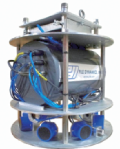
SHAPE 超音波による杭の孔径測定装置
