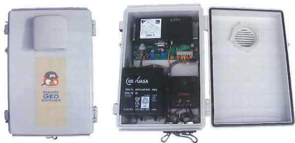
遠隔地下水総合監視装置
