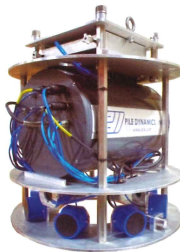
SHAPE 超音波による杭の孔径測定装置
