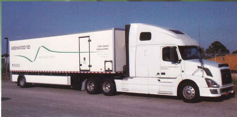
TSD(Traffic Speed Deflectometer: GREENWOOD ENGINEERING) は、レーザードプラー法による非接触型の連続走行たわみ試験装置です。従来のFWDに代わる革新的技術で、欧米で既に多くの使用実績を有しています。
